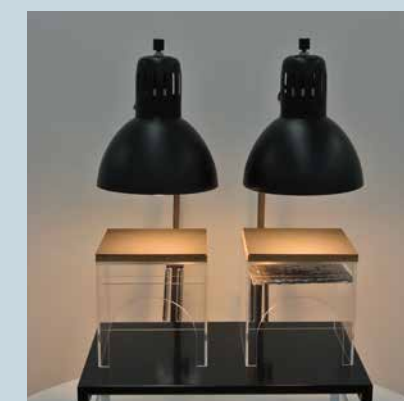
鉄板+合板を乗せたアクリルの箱の内部温度を、 建材アルミプチ。の有無で比較 ※外気温 28℃で測定
