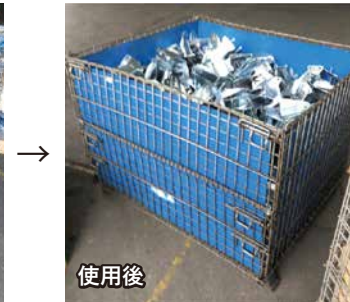
メッシュボックスパレットの積荷落下防止用内貼りボードとして採用 （アミーゴパネル）
