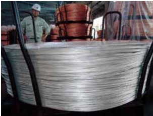
写真の線材は5tです。 更に5tの線材をのせて使用して頂いて おります。(使用銘柄PGPPZ-3000g/m 2 )
