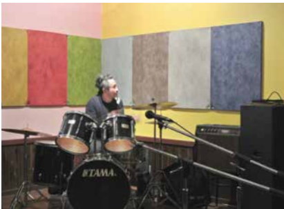
音を吸収する加工と、ウレタンを組み合わせ てライブ会場の残響音対策として採用 （吸音パネル）
