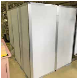
製品検査機の作動音対策として採用（吸音ブラパール+アルミフレーム）
