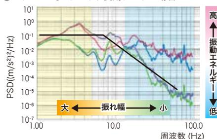
— エアサス車 — プラパール® ピタパッドエアサス — 板バネ車 — プラパール® ピタパッド板バネ
