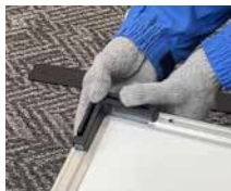
L型接続アダプターを パネル面に付けます。
